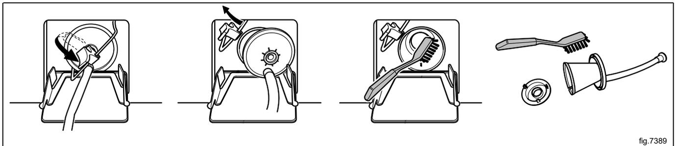
Beim Wiedereinbau das Filterteil mit der markierten Stelle nach unten wieder einsetzen. Achten Sie darauf, dass die Anschlüsse dicht sind.
