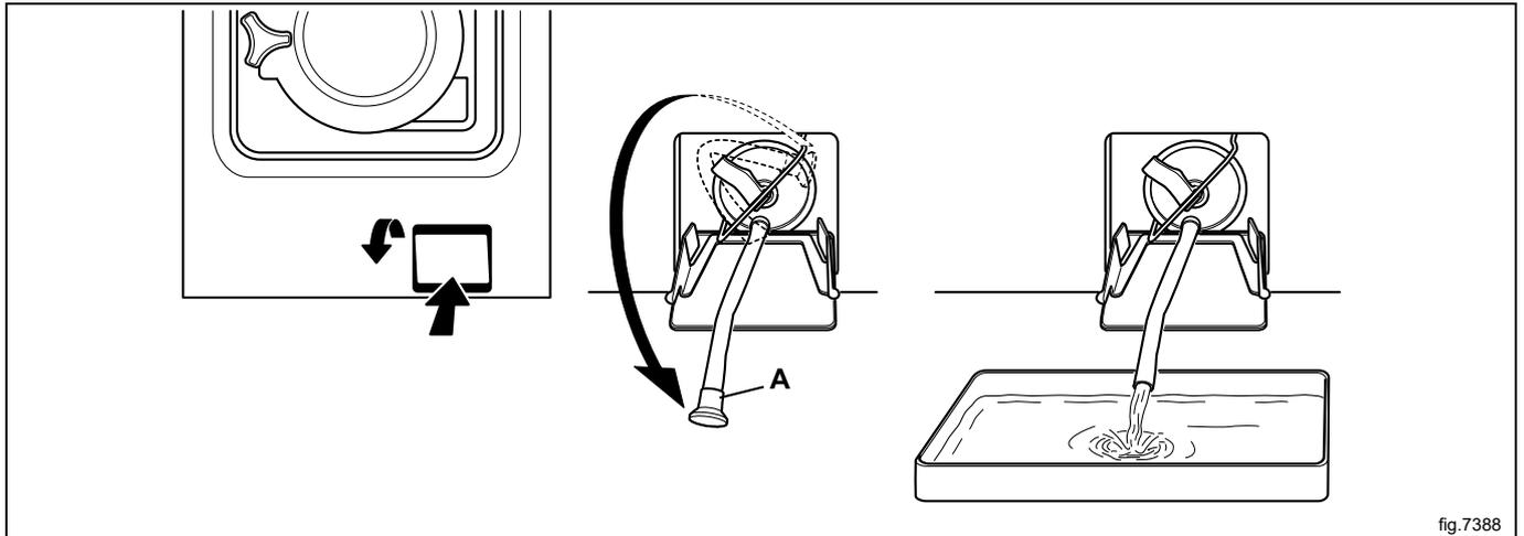
Ziehen Sie die Klemme nach oben und ziehen Sie die Filterteile heraus. Reinigen Sie die Filterteile und das Pumpengehäuse mit beispielsweise einer kleinen Bürste.
